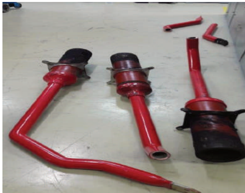
Fig. 7. Bushing extraídos en celda fallada.
